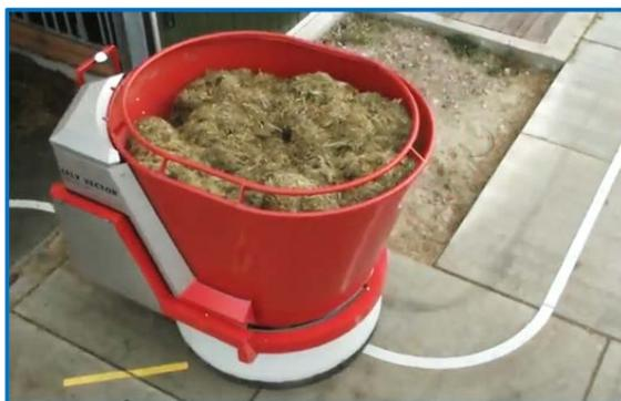
Рисунок 53 – Схема управления движением автономных кормовагонов
