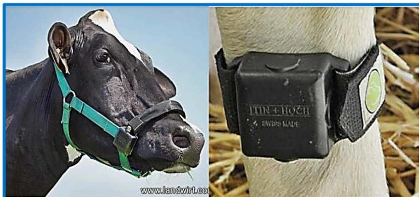
Рисунок 80 – Недоуздок и педометр RumiWatch
