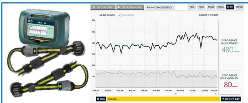
Рисунок 79 – Ошейник с биркой SCR HR-LD и график жевательной активности от программы SCR Heatime
