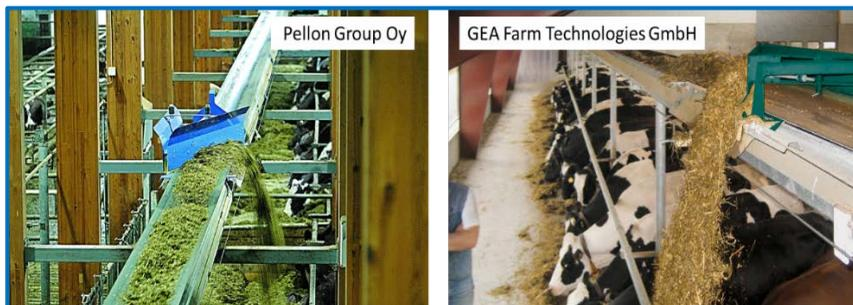
Рисунок 98 – Варианты ленточных транспортеров
