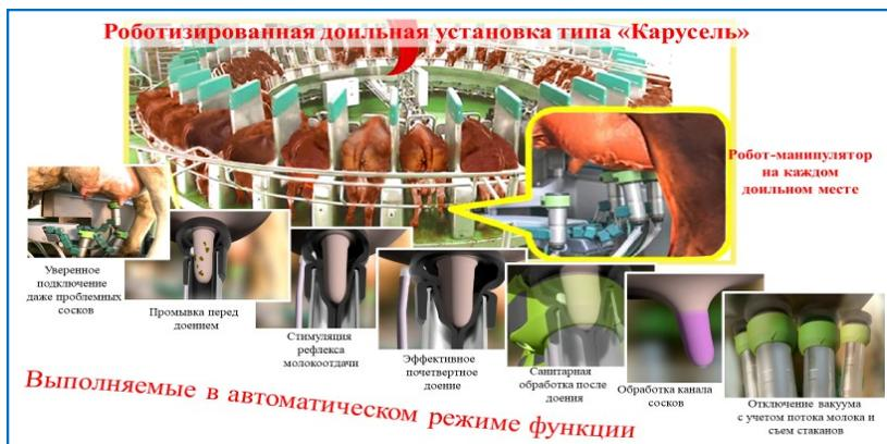
Рисунок 72 – Схема роботизированной доильной установки «Карусель» компании GEA FarmTechnologies DairyProQ
