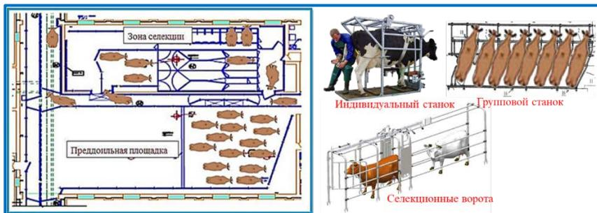
Рисунок 92 – Схема планировки предоильной площадки с селекционной зоной
