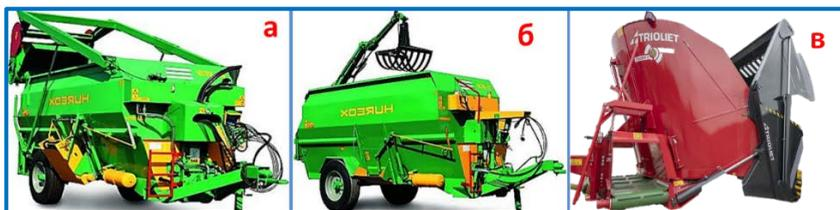
Рисунок 46 – Самозагружающиеся раздатчики: с фрезой (а); грейферным загрузчиком (б); механизмом загрузки ножом (в)
