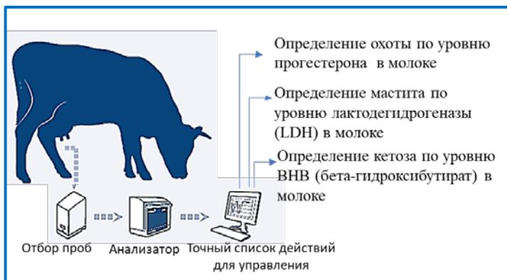
Рисунок 90 – Схема работы системы контроля физиологического состояния коров «Навигатор Стада™»
