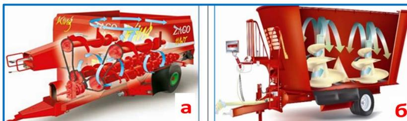
Рисунок 45 – Схема смесителей-раздатчиков с горизонтальным (а) и вертикальным (б) расположением смешивающих и измельчающих устройств
