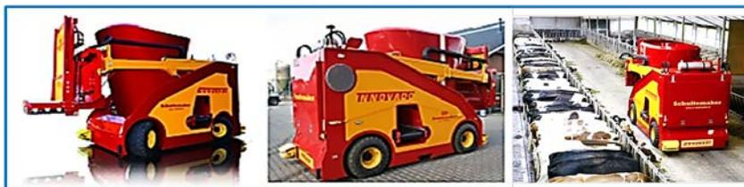
Рисунок 58 – Роботы-кормораздатчики мобильного типа с шасси
