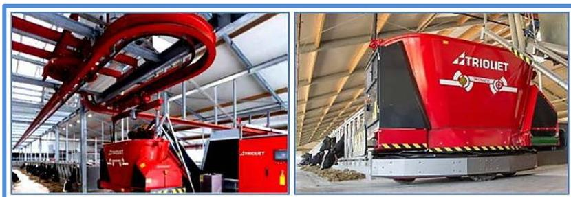
Рисунок 57 – Автоматизированная система кормления Triomatic T30
