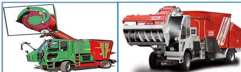
Рисунок 47 – Самоходные раздатчики с режущим щитом и фрезой
